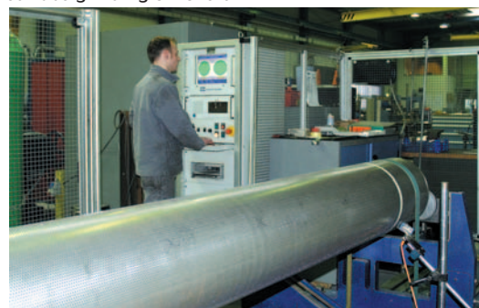
Auswuchten der Walzen Balancing of rollers
