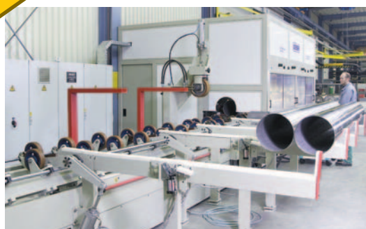
Oberflächenschleifen der Walzen Surface grinding of rollers
