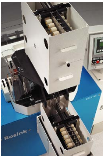
Oberwalzenmagazin vor und nach dem automatischen Schleifen
