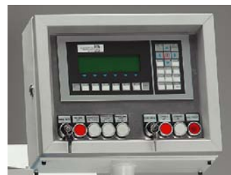
Bedienpult mit Display für automatisches Schleifen
